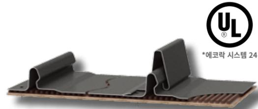
에코락 시스템은 실용신안등록된 제품으로 이음부 처리 공정 및 고정클립이 필요없는 획기적인 시스템입니다. 패널을 서로 끼워서 결합하는 방식을 취하며 클립없이 하지재에 바로 스크류로 긴결하는 방식의 에코락 시스템은 공기단축과 최고의 시공성을 자랑합니다. 돌출높이 24mm, 38mm 두 가지의 모델을 가지고 있으며 특히 에코락 38mm는 눈, 비가 많은 지역에 유리합니다.
